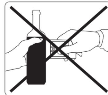
2.2.7. В случае некорректного приложения контактной площадки прибора к стенке емкости или недопустимой неоднородности стенки сосуда загорается мерцающий желтый индикатор.
