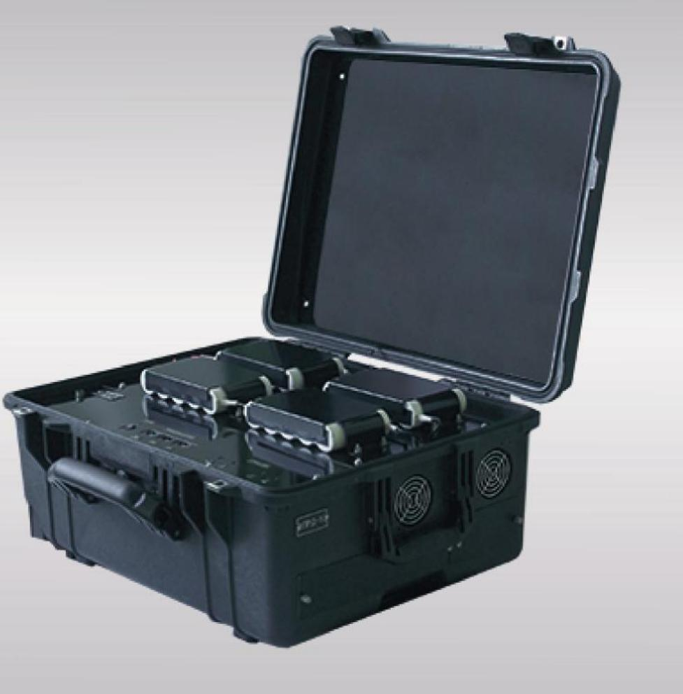
Изделие может эффективно использоваться как в качестве переносного защитного устройства, так и для защиты пассажиров автомобиля. Изделие предназначено для защиты от несанкционированного прослушивания с помощью специальных радиоустройств и предотвращения срабатывания радиоуправляемых взрывных устройств (РВУ). Используется в условиях, когда необходимо подавление сигналов в диапазоне частот, а также требуется дополнительная защита блокиратора от внешних механических воздействий.
