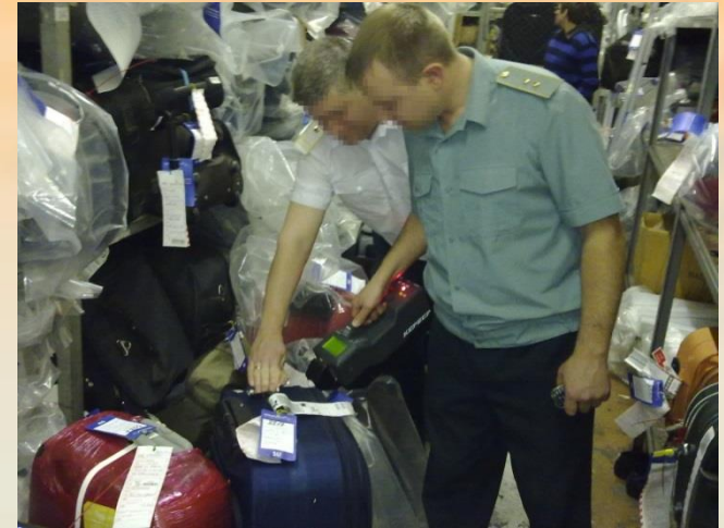
Использование ИДД Кербер сотрудниками таможенных органов для обследования невостребованного багажа
