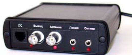
**Конвертер для поиска и анализа сигналов в сети 220 В, проводных линиях и оптическом ИК канале.**
