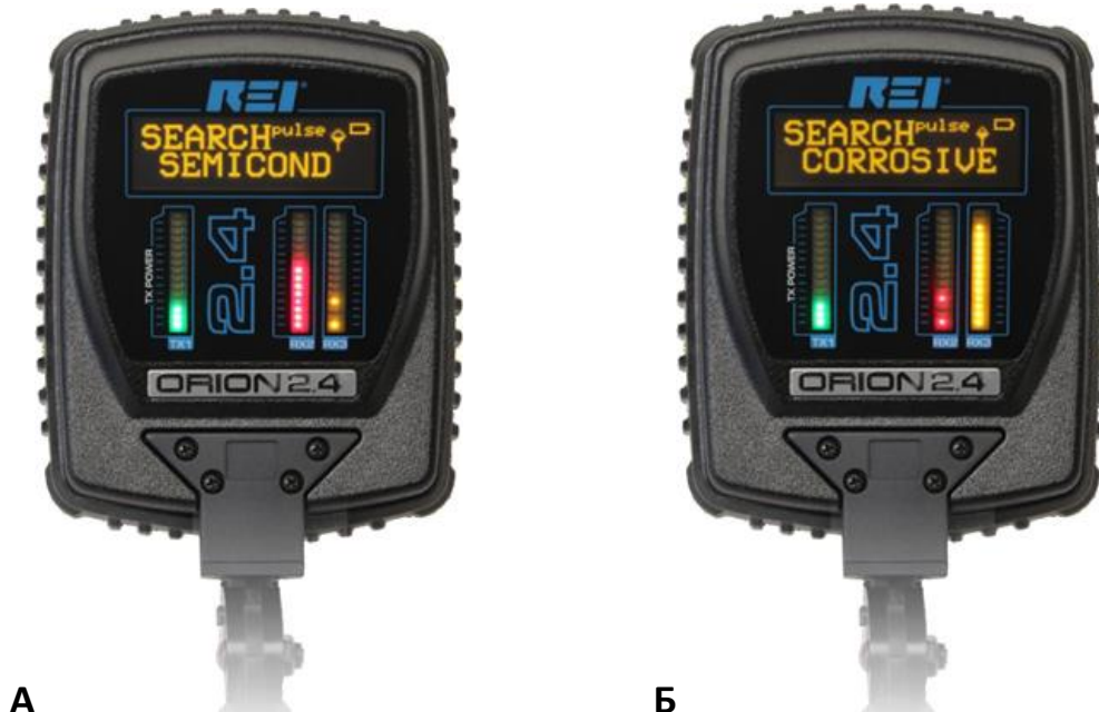
ORION 2.4 Сравнение уровней 2 ой и 3 ей гармоник
