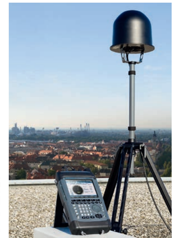
Портативный пеленгатор R&S®DDF007 в составе перевозимой станции контроля и пеленгации для временного стационарного использования
