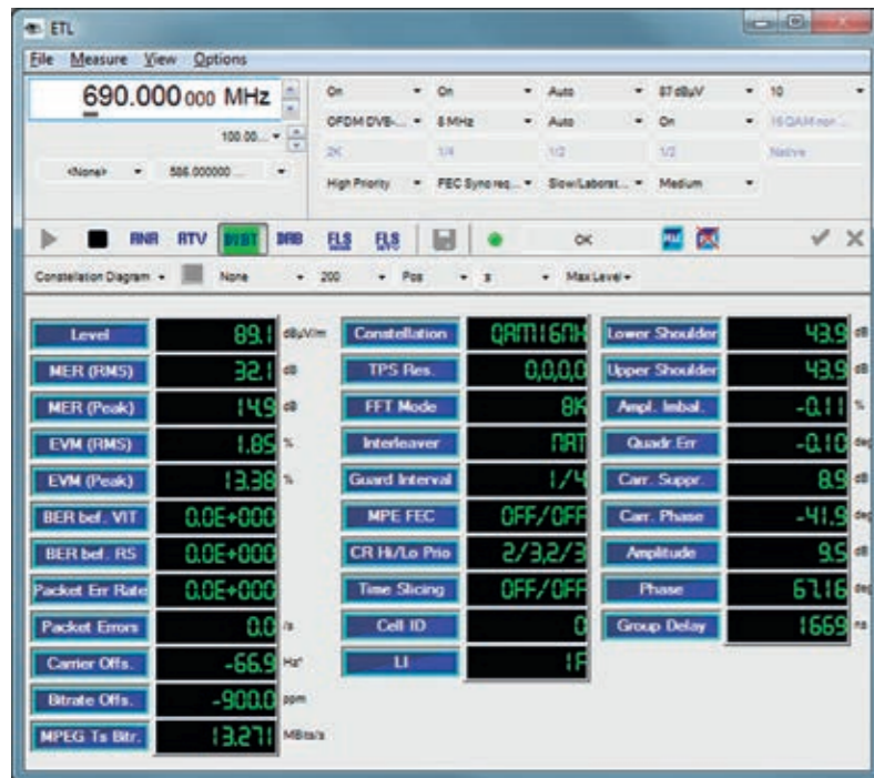
ПО R&S®ARGUS и анализатор R&S®ETL обеспечивают измерение сигнала DVB-T согласно
