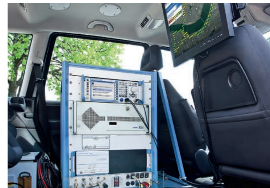
Анализатор ТВ-сигналов R&S®ETL с установленным программным обеспечением для измерения покрытия телерадиовещательных сетей R&S®BCDRIVE
