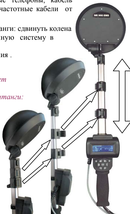
Рис. 52 Порядок сборки штанги
