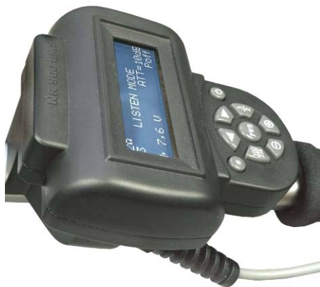
Рис.5 Общий вид пульта управления изделием NR-900EMS
