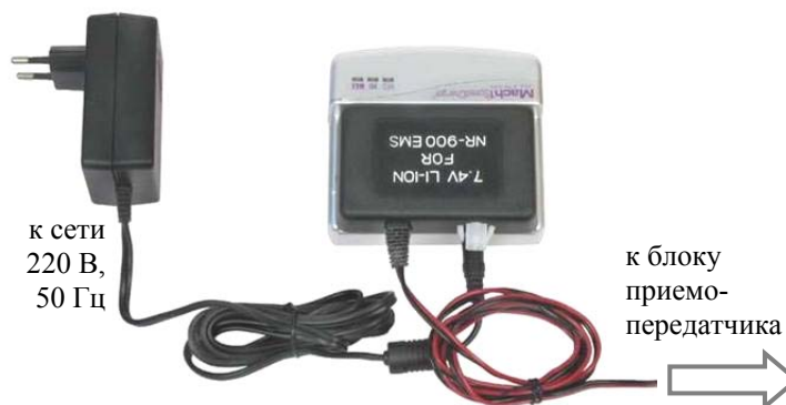
Рис. 66 Подключение ЗУ с сети переменного тока
