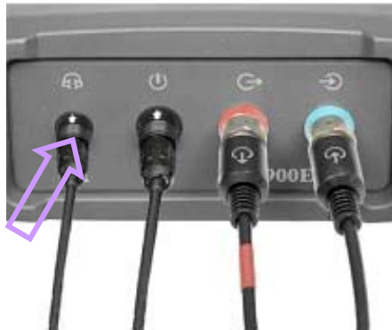
Рис. 44 Подключение кабеля головных телефонов
