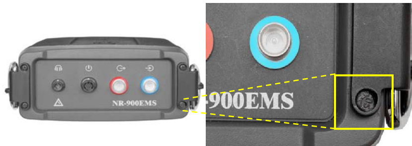
Рис. 37 Расположение пломбы на передней панели блока приемопередатчика
