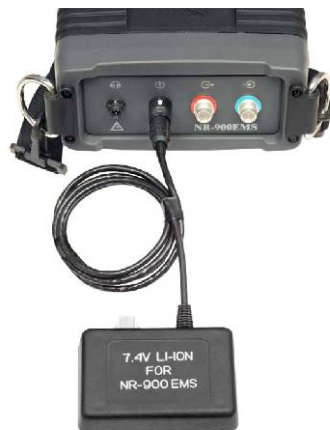
Рис. 64 Подключение адаптера ЗУ к блоку приемопередатчика
