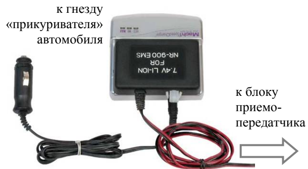
Рис. 67 Подключение ЗУ к бортовой сети автомобиля
