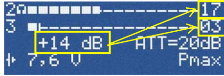
Рис.25 Разность уровней 2-ой и 3-ей гармоник, например, 17 - 3 = +14 дБ
