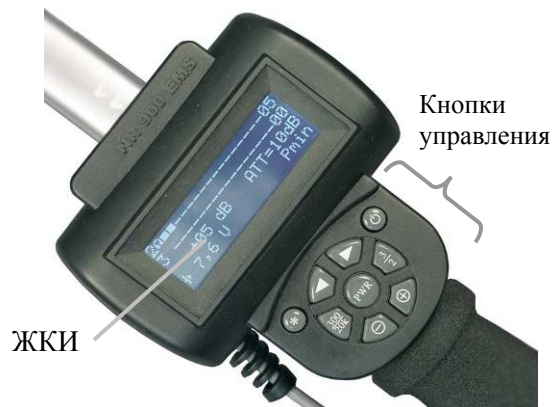
Рис. 20 Общий вид пульта управления изделием.
