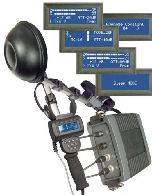
Рис. 1 Детектор нелинейных переходов NR-900EMS
