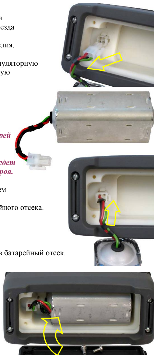
Рис. 72 - 75 Замена аккумуляторной батареи (II)
