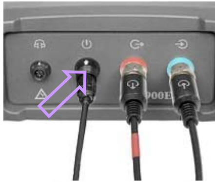
Рис. 43 Подключение кабеля пульта управления изделием
