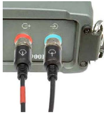
Рис.16 Соединение высокочастотных кабелей с блоком приемопередатчика
