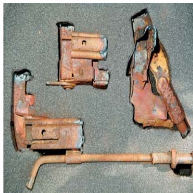
Рис. 8 Пример объектов с большим количеством «коррозийных» нелинейных отражателей
