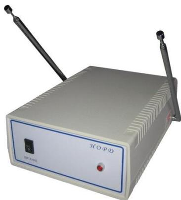
Портативный широкополосный генератор радишума малой мощности «Норд» предназначен для защиты от утечки информации и маскировки информативных побочных электромагнитных излучений и наводок персональных компьютеров и электровычислительной техники, подавления приемников дистанционного управления по радиоканалу в ближней зоне в диапазоне частот 0,1 – 2000 МГц.
