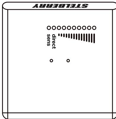
Регулировка направленности, чувствительности и режима направленности микрофона.
